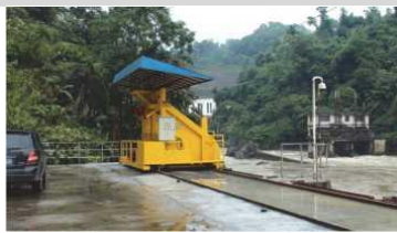
Мусороочистная машина для гидроэлектростанций (вид крупным планом)
