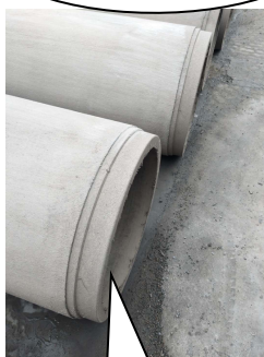
振动成型管道 即时脱模效果
