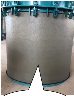
振动成型管道 即时脱模效果
