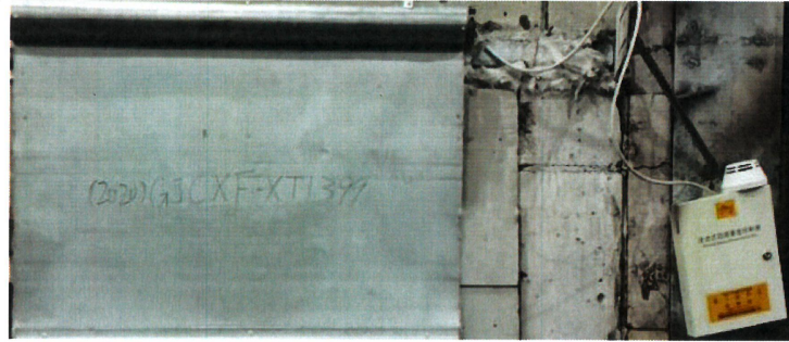
照片1 耐高温性能试验前试件情况
