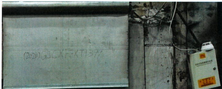
照片2 耐高温性能试验后试件情况
