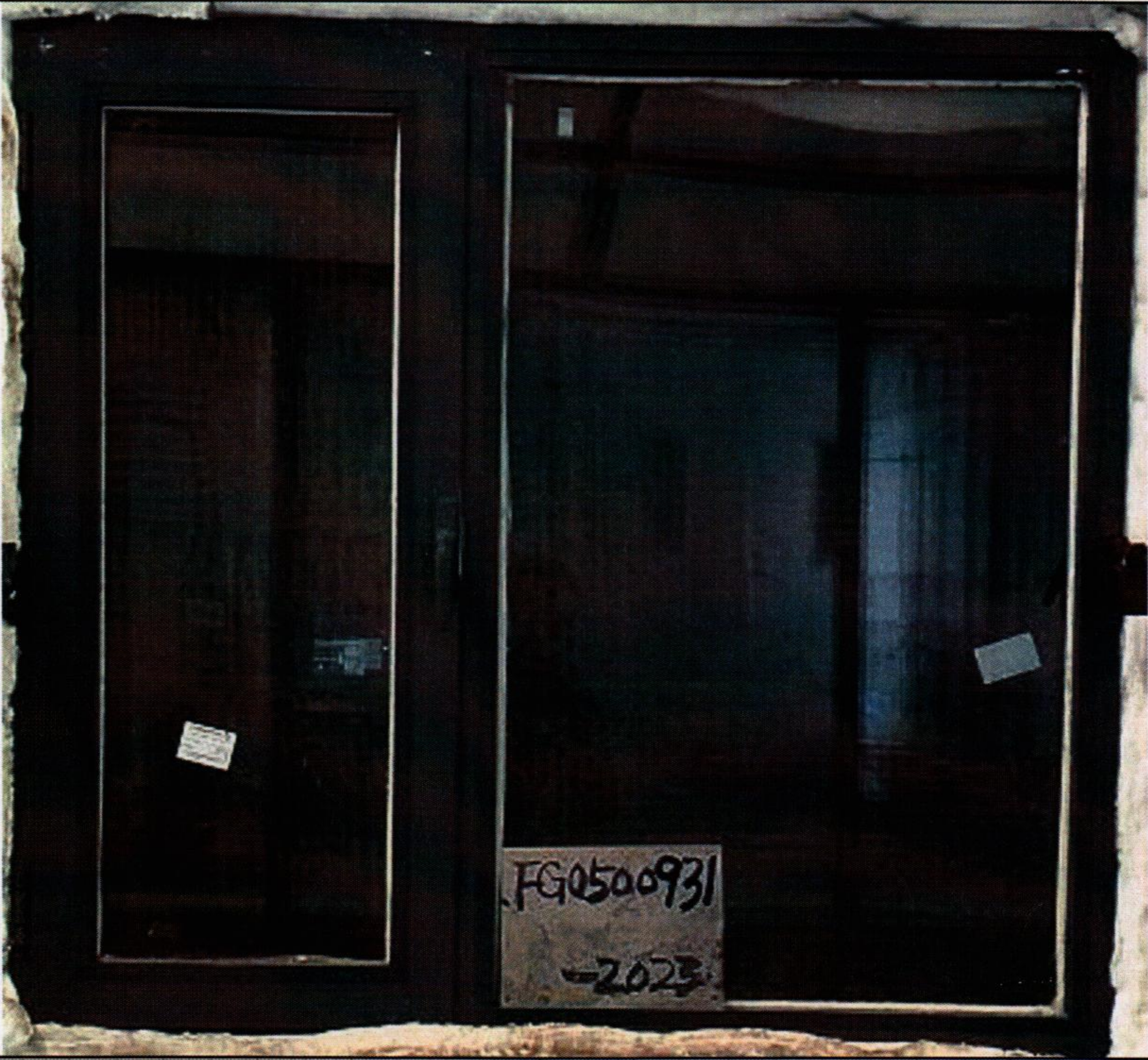
照片二 耐火试验结束时试件情况
