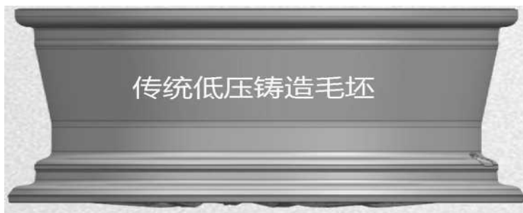
Заготовка, полученная методом традиционного литья под низким давлением
