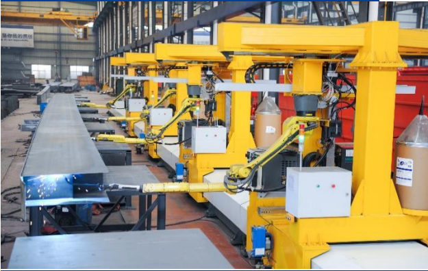
全自动双梁主梁内缝机器人焊接工作站 Automatic Robot Welding Workstation of Double Beam Main Beam
