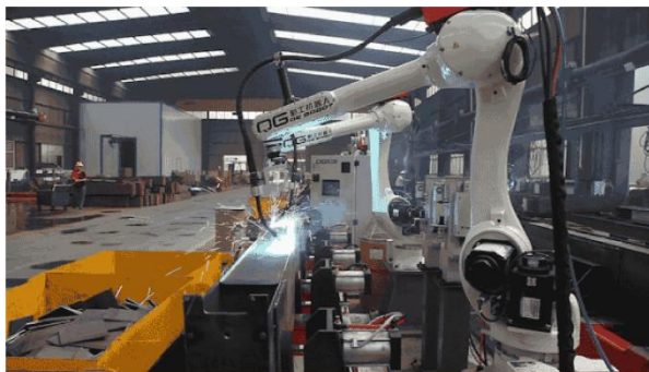
单梁端梁机器人焊接流水线
