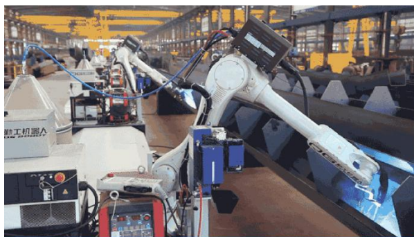
单梁主梁内缝机器人焊接流水线
